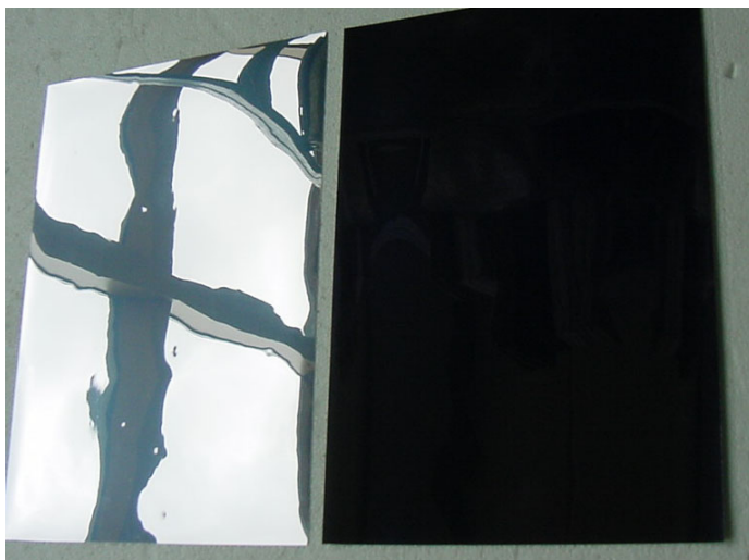
Bild 1 Photo der Probekörper links: Außenseite verspiegelte rechts: Raumseite nicht verspiegelt
